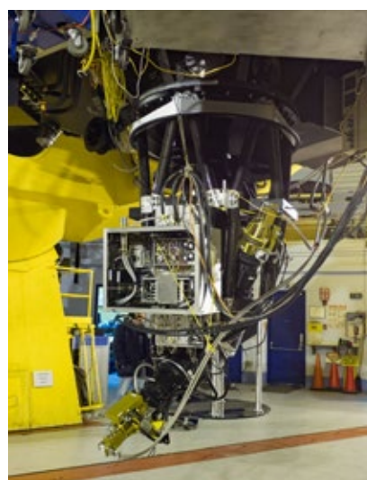
Fig.5. Le FTS imageur dénommé SITELLE au foyer Cassegrain du télescope CFH. En vert, on voit les deux caméras pour le domaine 350 - 970 \text{ nm} .
