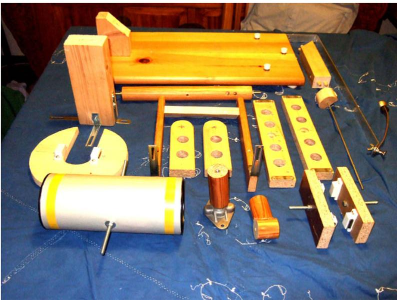
On voit ci-contre l'ensemble des pièces. Le télescope est un tube de carton fermé par un opercule métallique. Les pièces sont en bois (tasseaux, manches à balai etc...). Les trous circulaires percés dans certaines des pièces ont pour but d'en diminuer le poids.
