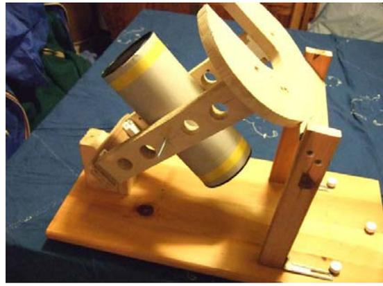
Monture en berceau et en fer à cheval (Le principe en est le même. La maquette permet d'expliquer clairement comment la monture en fer à cheval élimine la zone aveugle du pôle)
