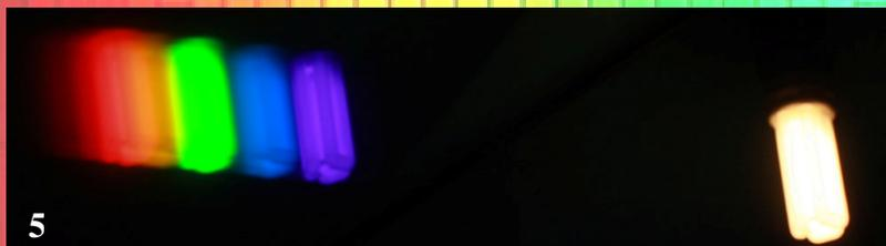
1. Rayons parallèles du Soleil ; 2. Double arc-en-ciel ; 3. Spectres de lampadaires à St-Jean-de-Losne ; 4. Laser vert et lampes rouges à l'école d'été du CLEA. ; 5. Lampe fluo et son spectre d'émission.
