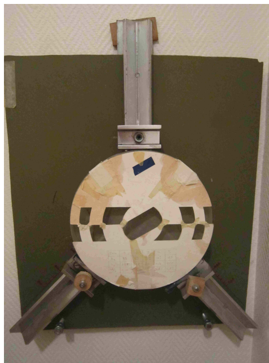
Cache : On utilise un cache (du carton fait très bien l'affaire) dans lequel sont découpées plusieurs zones. L'intensité de la lumière dans des zones diamétralement opposées nous renseigne sur la forme du miroir. On observe en fait la déformation par rapport à la sphère, pour laquelle on obtient une teinte plate (éclairage uniforme du miroir).■
