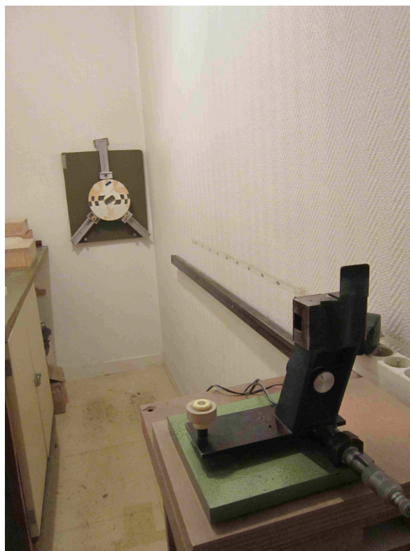
Foucault : Le principe du Foucault-mètre est d'envoyer un fin faisceau de lumière depuis de centre de courbure et d'observer sa réflexion en coupant les rayons réfléchis grâce à un couteau.
