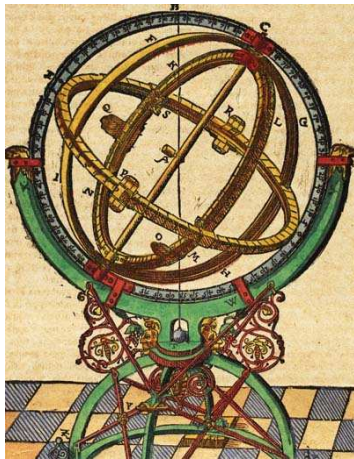
Fig.4. Dessin de la sphère de Tycho Brahé (1598). Modèle géocentrique d'observation, muni de pinnules.
