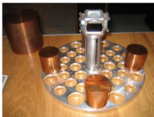
*Le fléau suspendu (plateau) avec ses petits cylindres, et un des cylindres attracteurs de la balance du BIPM.*
