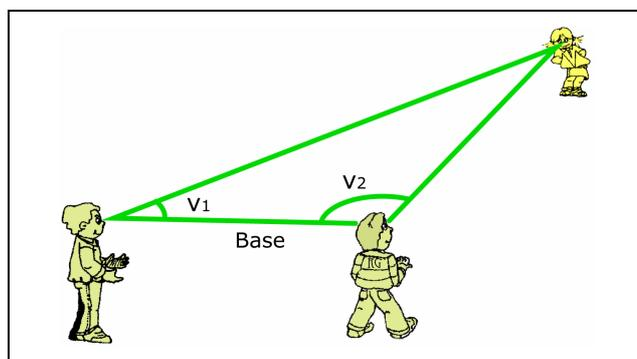
*Fig.1. Principe de la triangulation, permettant de déterminer une distance en mesurant des angles. C'est une méthode couramment appliquée par les géomètres et connue depuis l'antiquité. Connaissant la longueur de la base et les deux angles  $v_1$  et  $v_2$ , la géométrie du triangle permet de calculer les deux autres distances*
