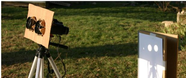
**Fig.3.** Observation du Soleil par projection derrière une paire de jumelles fixée sur un pied photo. Ce type d'installation est à surveiller constamment pour éviter qu'une personne regarde à travers les jumelles et se brûle les yeux.
