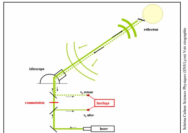
*Fig.2. Schéma de principe de la télémétrie laser.*
