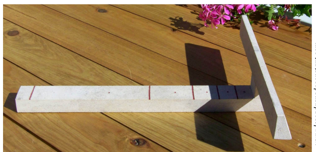
Fig.2. Principe d'un cadran solaire égyptien de l'époque de Thoutmosis III (1479-1425 av. J.C.). La tablette graduée est orientée est-ouest et l'ensemble doit être retourné à midi. (reproduction moderne).
