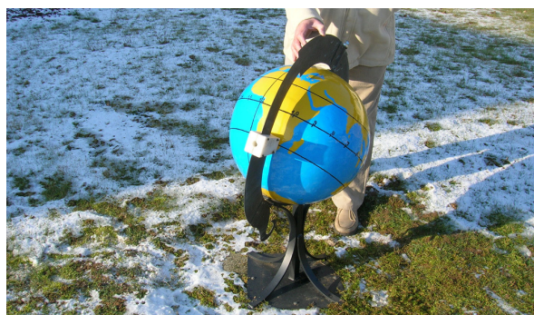
Fig.2. Le cadran est installé mais il faut encore tourner le méridien pour avoir l'heure.
