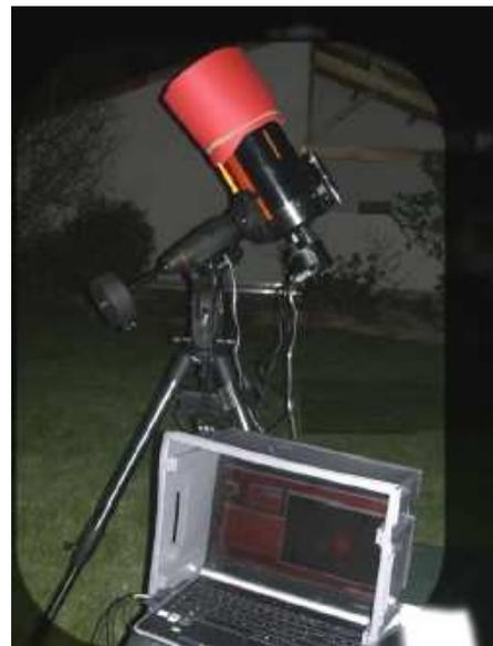
Télescope et caméra CCD utilisés.
