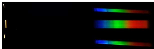
Fig.7. Spectres de Véga, Arcturus et Alioth (de haut en bas), obtenus avec une lunette de 500 mm de focale, un réseau blazé à 200 traits/mm et un APN.
