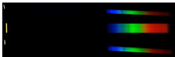
Fig.7. Spectres de Véga, Arcturus et Alioth (de haut en bas), obtenus avec une lunette de 500 mm de focale, un réseau blazé à 200 traits/mm et un APN.
