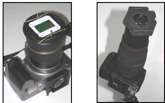
Fig.1. À gauche, réseau CLEA sous cache diapo et à droite, réseau blazé fixé sur un zoom.
