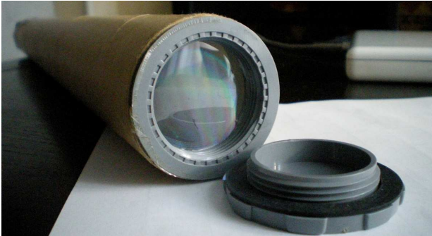
Fig.4. Le réseau installé.
