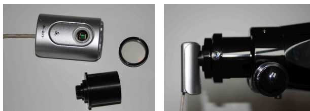
Fig.4. Montage avec une webcam. À gauche, la webcam (sans son objectif), l'adaptateur et le réseau. À droite, l'ensemble fixé sur le porte oculaire d'une lunette.
