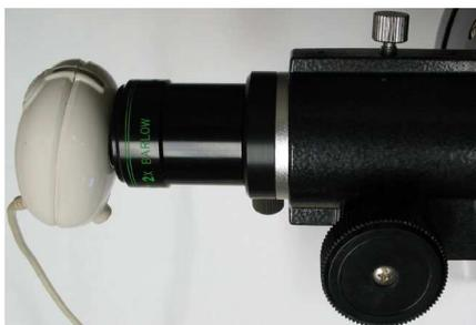
Fig.9. Installation de la webcam sur la lunette (ici avec une barlow).
