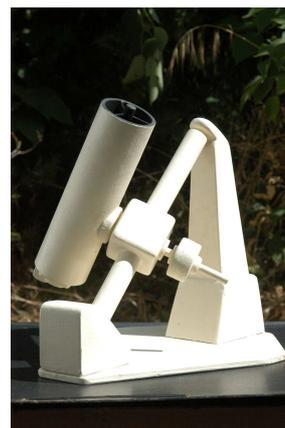
*Télescope sur monture équatoriale anglaise : les grands télescopes de l'observatoire de Haute Provence.*
