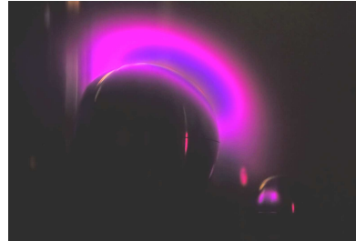
Simulation de phénomènes auroraux grâce à "la planeterella" mise au point par J. Lilensten. Crédit photo : C. Simon ESTEC/LPG
