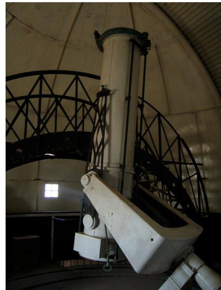
*Le télescope de Foucault est équipé d'un des premiers miroirs de 60 cm, en verre aluminé.*
