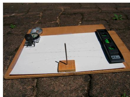
Au milieu d'un grand bord de la feuille on place le gnomon (le support du gnomon est dessiné en position et le support fixé sur la feuille (ruban adhésif). Le centre du socle est déterminé précisément; il doit correspondre au centre du gnomon.
