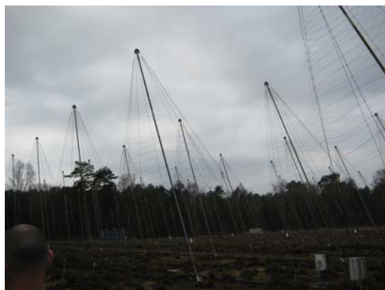
Photo 4 : Le réseau décamétrique de Nançay. Chaque antenne (perche en forme de sapin) constitue un élément d'une sorte de "lentille plane". Ce réseau est utilisé pour étudier les sursauts radioélectriques de Jupiter ou de la couronne solaire.
