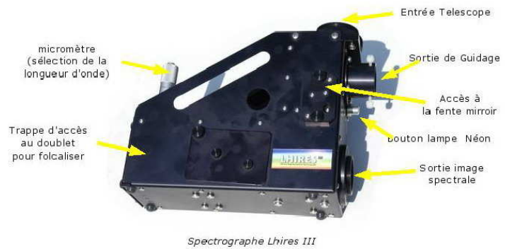
Figure 4 : Schéma et vue du spectrographe.
