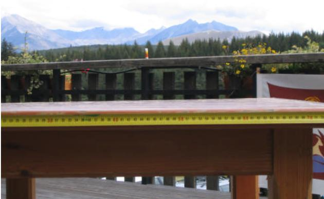
*Photo de l'objet dont on cherche la distance (tube de colle posé sur la barrière). Le ruban de calibration est fixé à un mètre de l'appareil photo..*
