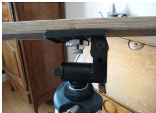
*Fixation de la barre sur un pied photo par taraudage dans le bois.*
