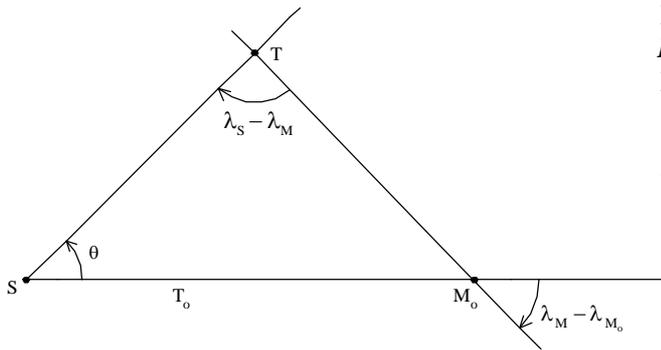
Les constructions à la minute d'angle près étant bien difficiles à réaliser, nous calculerons la position de T (en utilisant les relations d'Al Kashi) en coordonnées polaires :
