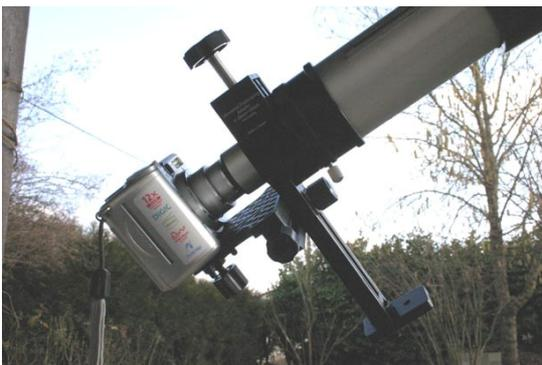
*L'adaptateur est fixé ici sur le porte oculaire (et non sur l'oculaire) d'une lunette de 102 mm de diamètre de qualité moyenne. J'ai juste enlevé une vis de fixation du porte oculaire pour la remplacer par une plus courte. On peut aussi fixer l'adaptateur directement sur l'oculaire si l'APN est léger.*
