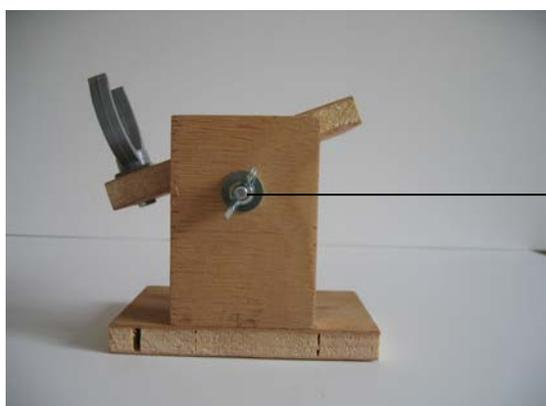
Figure 7 : support de l'objectif photo vu dos
