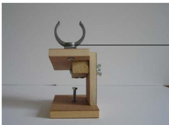
Figure 6 : support de l'objectif photo vu de profil
