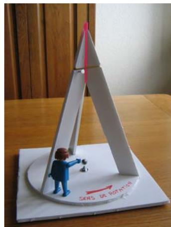
Pincez le plomb autour d'une extrémité du fil (dans un étau) et faites une boucle à l'autre extrémité du fil. Passer la boucle dans la paille et fixer la avec le clou dans un des supports, de telle manière que le plomb affleure le boulon central, sans le toucher.
