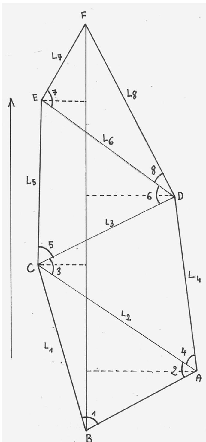
*Figure 1 : Mesure d'une longueur avec un rapporteur !*
