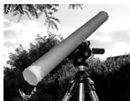
On vise le Soleil sans le regarder, en utilisant l'ombre du tube, et on obtient une tache lumineuse sur le calque, c'est l'image du Soleil. Celle-ci est relativement petite, à peine 1 cm pour un tube de 1 m de long.
