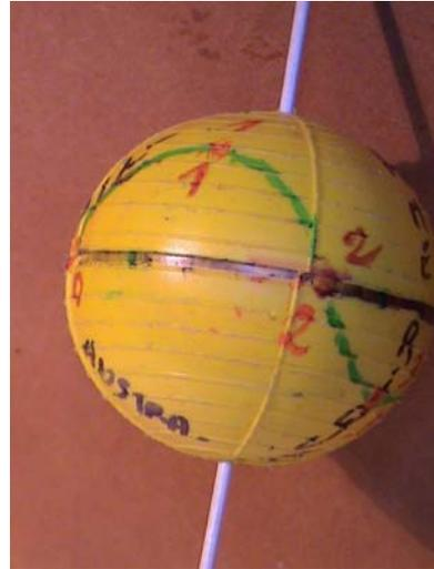
**Fig. 4:** Trace de l'orbite sur la Terre obtenue par les pointages successifs (0, 1, 2,...) correspondant respectivement aux instants 0,  $T/4$ ,  $T/2$ ... On observe l'aspect « sinusoïdal » et la réduction de la période angulaire à  $A = 180^\circ$  environ. Il y a en effet un quart de période  $T$  (passage de 0 à 2) pour  $90^\circ$  de longitude terrestre.
