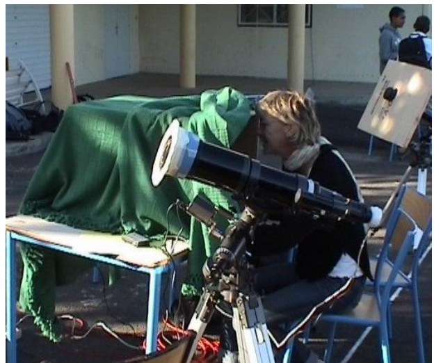
Me voici avec la lunette 80/480 motorisée munie d'un réducteur de focale, d'un filtre et d'une webcam
