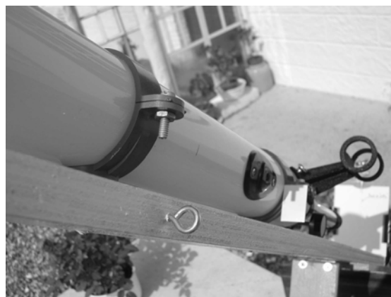
3 - Visée du Soleil avec l’ombre d’une vis.
