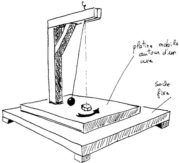
**IMAGE 2 :** Avant de faire la théorie, je vous conseille de réaliser le petit instrument décrit dans cette figure. C'est très simple et je vous garantis un effet très spectaculaire. Un petit pendule simple est tenu par une potence montée sur une platine mobile autour d'un axe, aligné avec le fil du pendule au repos. Lancez le pendule et faites tourner la platine autour de son axe. Vous verrez que le pendule oscille toujours dans le même plan.
