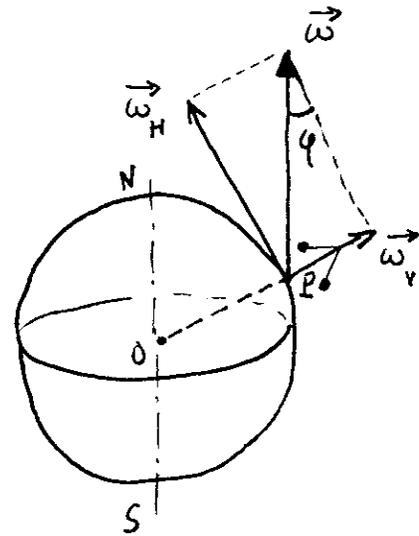
**IMAGE 5 :** En P le vecteur  $\omega$  peut être vu comme la somme de deux vecteurs  $\omega_H$  et  $\omega_V$ . Le pendule voit donc deux rotations. Quels sont les effets de ces deux rotations ?
