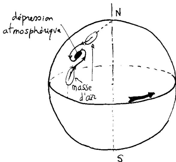
**IMAGE 14** : Une dépression atmosphérique va attirer les masses d'air environnantes. Les masses venues du sud et montant vers le nord (toujours en se plaçant dans l'hémisphère nord) vont dévier vers l'est. En revanche les masses d'air qui descendent du nord vont dévier vers l'ouest. Les masses d'air vont donc toujours manquer leur but et s'enrouler en spirale.
