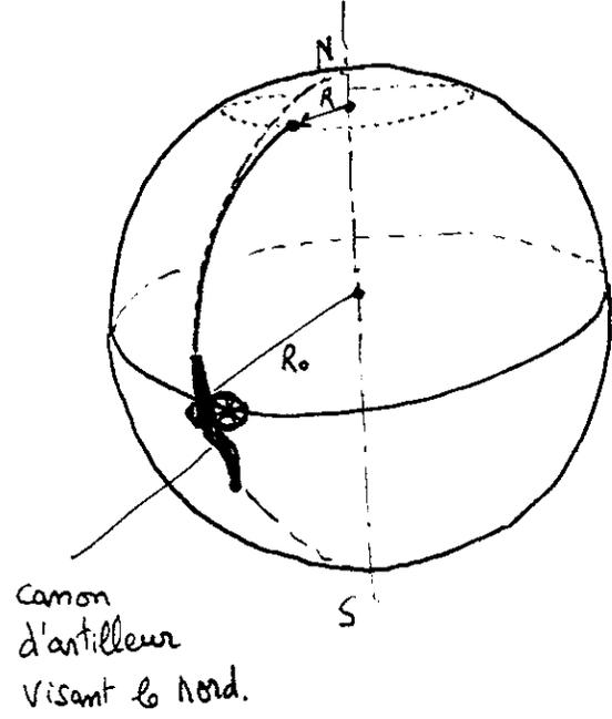
**IMAGE 12** : Les conséquences de cette accélération étaient connues depuis longtemps. Les artilleurs avaient noté qu'un boulet de canon tiré vers le nord (dans l'hémisphère nord) déviait vers l'est. Ce phénomène s'explique si on réalise que le boulet, en montant vers le nord se rapproche de l'axe de rotation terrestre.
