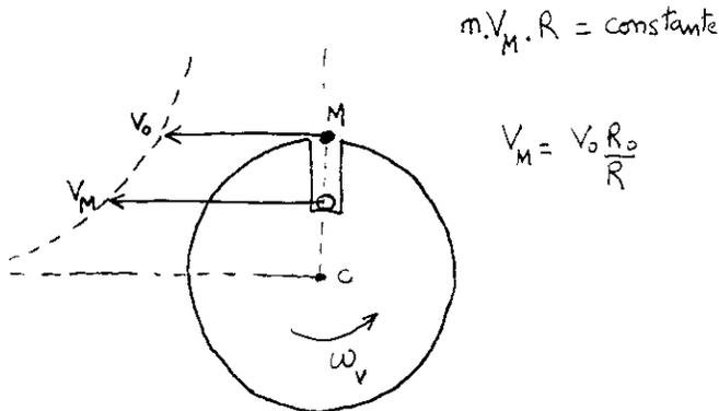
**IMAGE 11** : La réponse est NON. Plus la masse s'approche du centre plus sa vitesse horizontale augmente.
