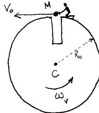
**IMAGE 9 :** Avant de laisser tomber la masse dans le puits, l'opérateur la maintient. Cette masse est donc assujettie à garder la même vitesse ( $V_0$ ) que la margelle du puits.
