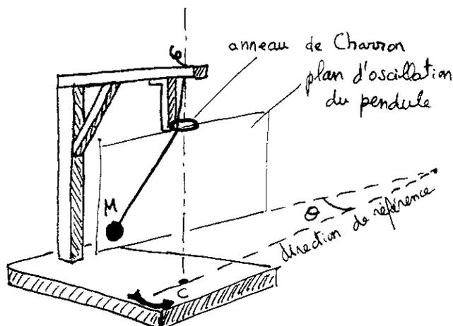
**IMAGE 15** : Revenons sur le pendule de Foucault-Charron entretenu électriquement. L'anneau, que nous avons appelé l'anneau de Charron du nom de son inventeur, servait essentiellement à établir un contact électrique quand le pendule était hors de sa position d'équilibre. Un électro-aimant était alors excité qui ramenait le pendule vers le centre avec un petit surcroît d'énergie compensant les pertes dues, pour l'essentiel, à la résistance de l'air.
