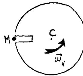
**IMAGE 8 :** L'étude du pendule au point P se ramène donc à l'étude au pôle, mais avec une vitesse de rotation plus lente. Pour aller plus avant dans la compréhension du phénomène, nous pouvons remarquer que le mouvement de la masse pendulaire (la sphère, quoi !) est celui d'un corps libre M attiré par un centre C, dans un système en rotation. Il serait équivalent d'étudier une masse M tombant dans un puits, sous l'effet de l'attraction de la Terre en rotation  $\omega_V$ .
