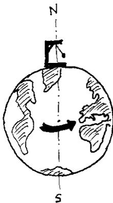
**IMAGE 3 :** Nous avons reproduit ainsi ce que nous aurions obtenu à un pôle terrestre, avec un pendule classique, la platine mobile étant constituée par la Terre elle-même.
