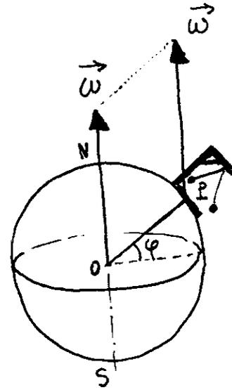
**IMAGE 4 :** En dehors du pôle le phénomène se complique. Supposons que nous installions notre pendule en un lieu (point P) de latitude  $\varphi$ . La rotation de la Terre peut se représenter par un vecteur  $\omega$ . (nous adoptons pour le texte la notation anglo-saxonne qui veut que les vecteurs soient écrits en caractères gras).
