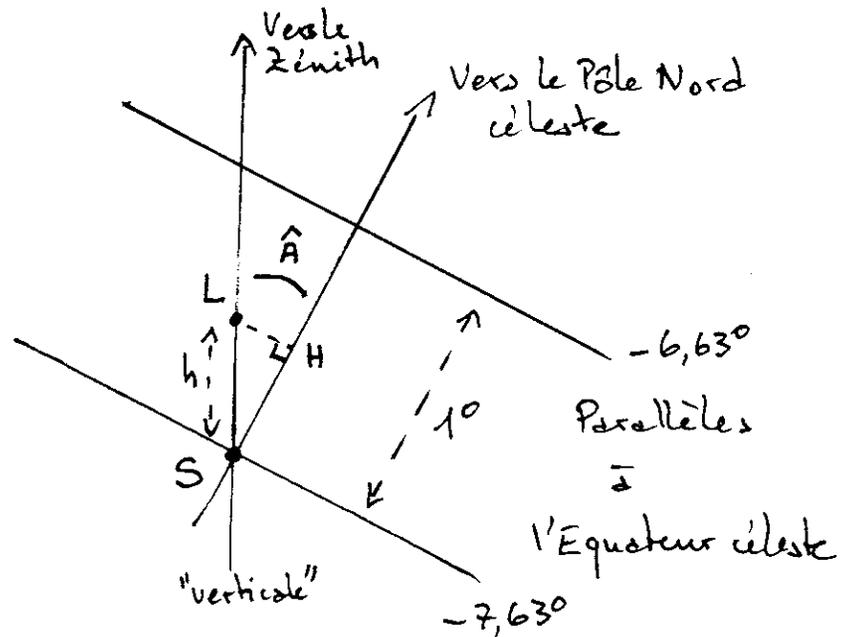
Pôle Nord céleste-Soleil-Zénith, on peut obtenir  $\hat{A}^2$  et modifier la relation obtenue plus haut  $\alpha = 1^\circ - h^\circ$  en  $\alpha = 1^\circ - h^\circ \cos \hat{A}$ .
