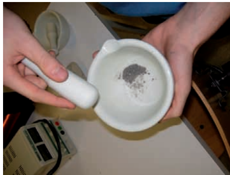
2-Début du concassage de la pierre composée de pyroxène et d'olivine
