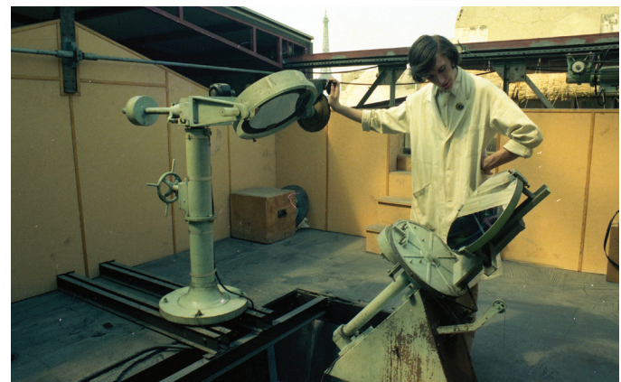
11. Le cœlostate sur le toit du Palais projetait une image du Soleil à la verticale, en direction de la salle du Soleil accessible aux visiteurs. (Crédit : EPPDCSI/C. Rousselin)
