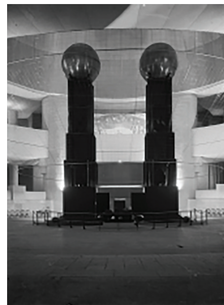
3. Le générateur électrostatique de type Van de Graaff, réalisé et installé dans le hall d'Antin du Palais de la découverte, durant l'Exposition internationale des arts et techniques de 1937. (Crédit : EPPDCSI)
