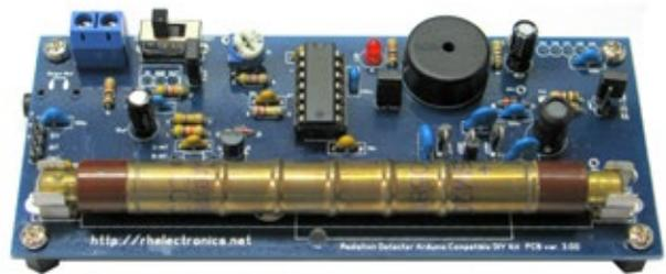
Fig.8. Le compteur Geiger utilisé pour les mesures
